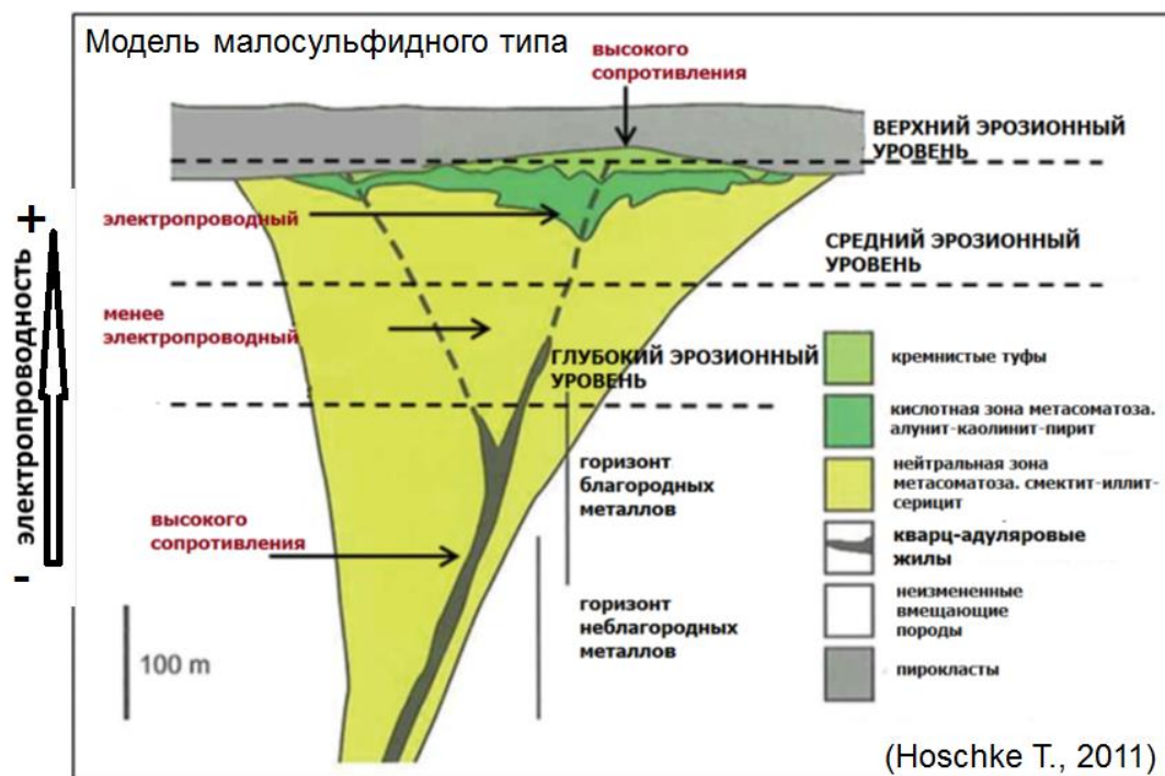
Рис.4 Схематичная модель малосульфидного эпитеермального месторождения с представлением зависимости электрического сопротивления от эрозионного уровня.
