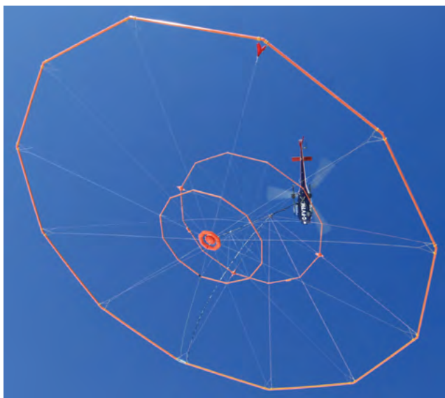
Рис. 3. ЭМ-система VTEM с магнитным градиентометром, контролируемым GPS и гироскопическим инклинометром
